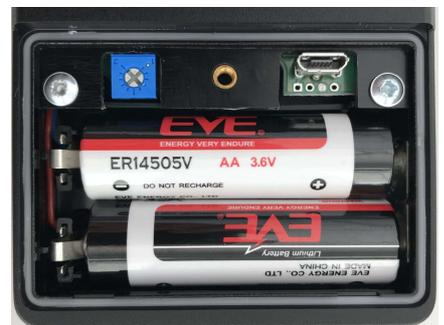
Batteriefach mit Trimmer u. USB-Buchse
