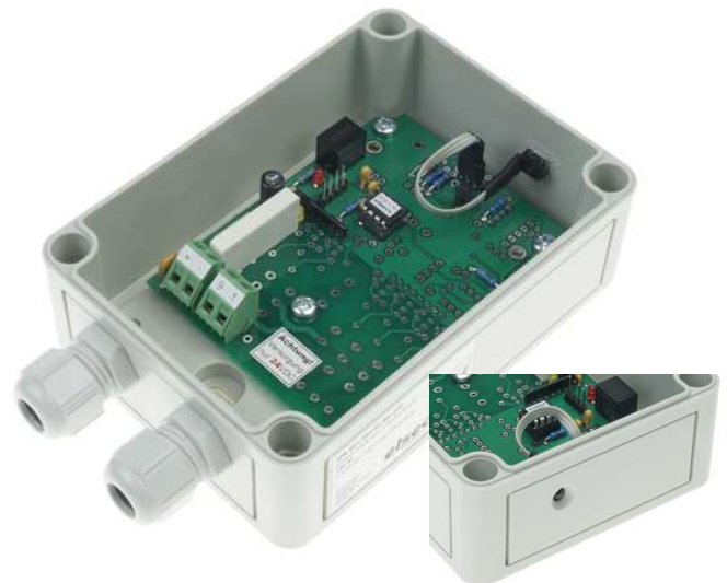
IR-Empfänger EFB-EK1-PS130-IRE (IR-Empfangsdiode in der Front)
